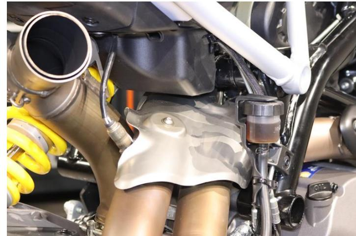
IT · Rimontare la protezione (senza cavo di comando valvola) come in origine
