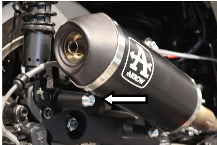
**IT** · Posizionare la boccola copri attacco nell'attacco inutilizzato
