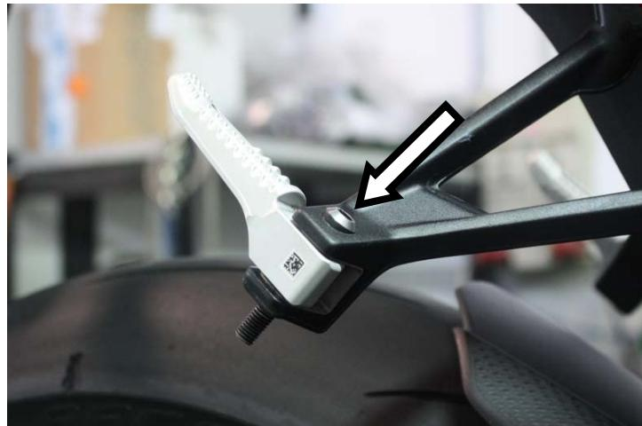
**IT** · Togliere il fermo, sfilare il perno del pedalino e sostituirlo con quello fornito
