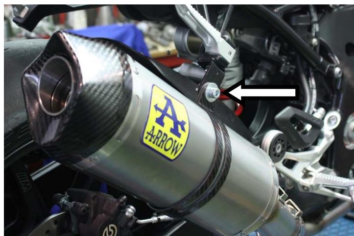
**IT** · Innestare il terminale e serrarlo alla staffa mediante fascetta di sostegno
